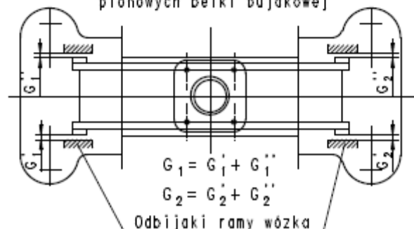
Pomiar luzów na ślizgach pionowych belki bujakowej
